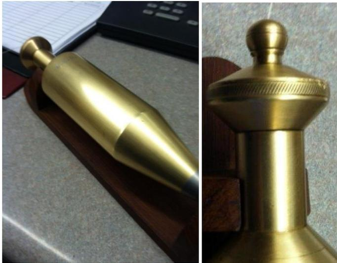
AUS DIESEN GRÜNDEN SOLLTE HG GESICHERT SEIN DURCH EINE ZWEITE VERSCHRAUBUNG (WIE IN DEINEM FALLE). SO KANN DAS QUECKSILBER NICHT VERSCHÜTTET WERDEN, WENN DU DEN KOPF ABSCHRAUBST, UM DIE SCHNUR ZU WECHSELN.
