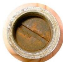
ANDERE HERSTELLER BENUTZEN ZWEI LÖCHER (ANSTELLE EINES SCHLITZES), UM DAS ÖFFNEN MIT EINEM NORMALEN SCHLITZSCHRAUBENDREHER ZU ERSCHWEREN. (SIEHE BILD RECHTS) DEINE SCHRAUBE IST WIE BEI DEM STARRETT LOT.
