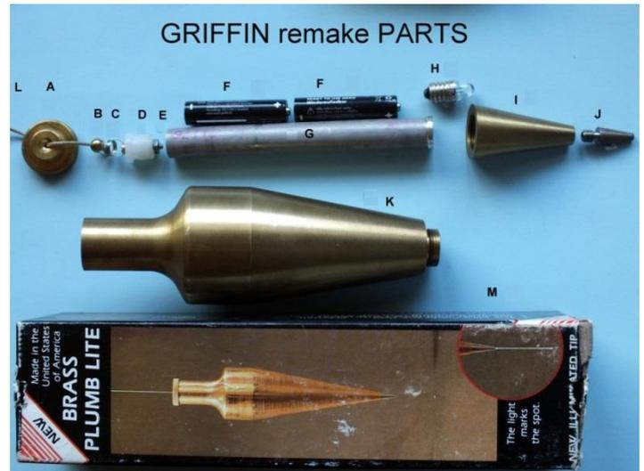
KNOTEN AM ENDE DER SCHNUR MACHEN. DAS SYSTEM WIRKT FOLGENDERMASSEN: DER STROMKREIS IST OFFEN, DENN DIE FEDER C ZIEHT DIE KUGEL B VON DER SCHRAUBE A WEG. WENN DAS LOT AN DER SCHNUR L HÄNGT (ARBEITSPOSITION), ZIEHT DIE SCHNUR L DIE KUGEL B GEGEN DIE SCHRAUBE A UND DER STROMKREIS IST GESCHLOSSEN. DIE BIRNE LEUCHTET. WENN MAN DAS LOT ZURÜCK IN DIE
