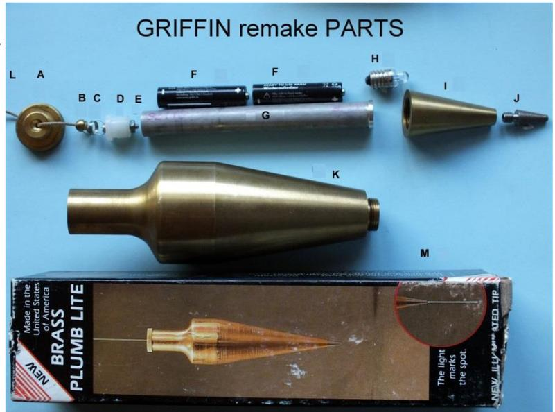
**KNOT AT THE END OF THE LINE. THE SYSTEM WORKS AS FOLLOWS: THE ELECTRIC CIRCUIT IS OPEN, BECAUSE THE SPRING C PULLS THE BALL B AWAY FROM THE SCREW A. WHEN YOU HOLD THE PLUMB BOB ON THE LINE L (WORKING POSITION), THE LINE L PULLS THE BALL B AGAINST THE SCREW A AND THE ELECTRIC CIRCUIT IS CLOSED, THE LAMP IS LIGHTED. WHEN YOU PUT THE PLUMB BOB BACK INTO THE TOOLBOX, THE SPRING C PULLS THE BALL B BACK AND B HAS NO CONTACT TO A. LIGHT IS OFF.**
