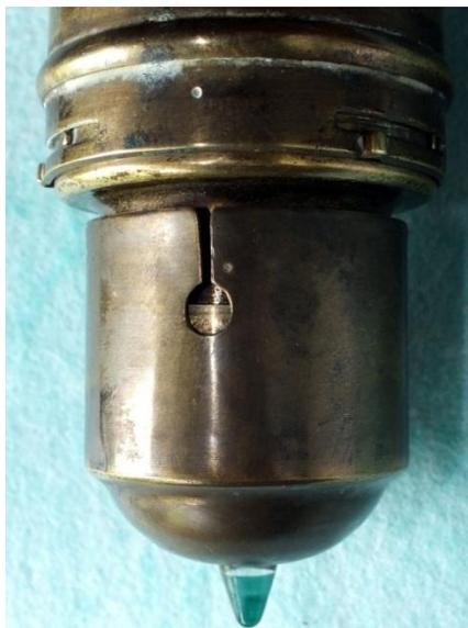
Durch die Messingblende wird die Linse abgedeckt und lässt nur eine (farblich eingefärbte) Spitze als Zielpunkt erleuchtet frei
