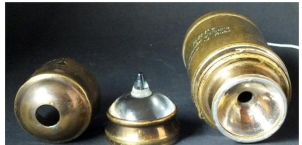
Rohrförmiger Aufsatz, Linse; Gehäuse mit Reflektor
