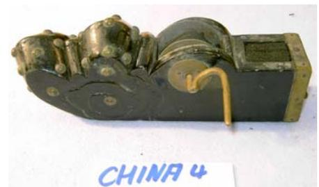
C3 c) Später wurden die Teile auch komplett aus Messing hergestellt als Topf mit einer seitlich angebrachten Spule.
