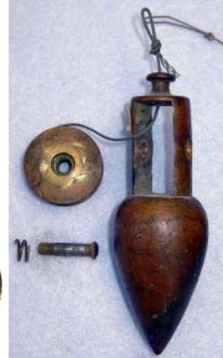
20) **Kopf als Lichtquelle** wie im Falle von Bergwerksloten. Die Bergwerkslot kommen vor als normale Senklote und Spitzlote. In anderen Fällen wird die Schnur durch eine kardanische Aufhängung an einem Kettengehänge ersetzt. Der Kopf des Lotes fungiert hierbei als Halter für eine Flamme.
